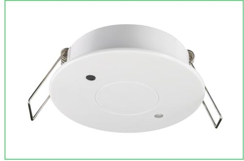
DALI-2 Multisensor mit Mikrowellen-Präsenzmelder und Lichtsensor zur Deckenmontage. Für smarte Lichtsteuerung, 12–36 V DC, D4i-kompatibel.
